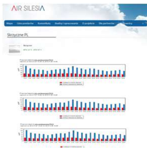
Obr. č. 26 Vizualizace průběhu 24 hodinových koncentrací znečišťujících látek v ovzduší s krokem 1 hod. pro dané měřicí místo.
